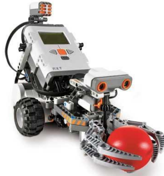
Şekil 9. İstenen Renkte Topu Otonom Olarak Arayıp Bulan Robot.
